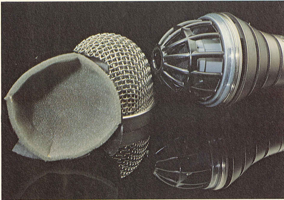
Sotto la cupola, in rete d'acciaio di pregevole fattura, è alloggiata la protezione antipop ed un'ulteriore protezione in plastica.
